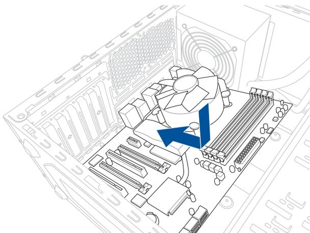
3. 下図を参考に、取り付けのネジをすべて仮止めし、対角線上に少しずつ締めていきます。
