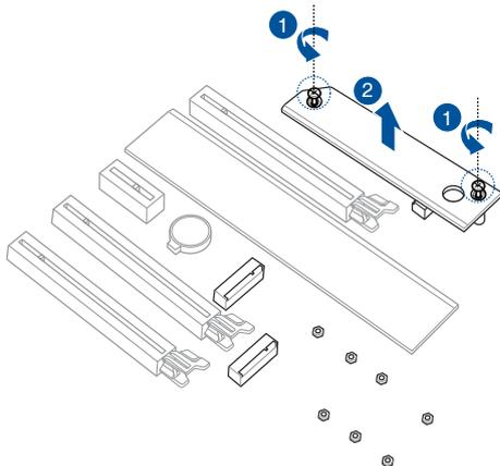
3. M.2 Socket 3 スロットにM.2 SSDを取り付けます。長さの異なるM.2 SSDを取り付ける場合は、手順が異なる場合があります。各タイプの取り付け手順を参考に作業を行ってください。
