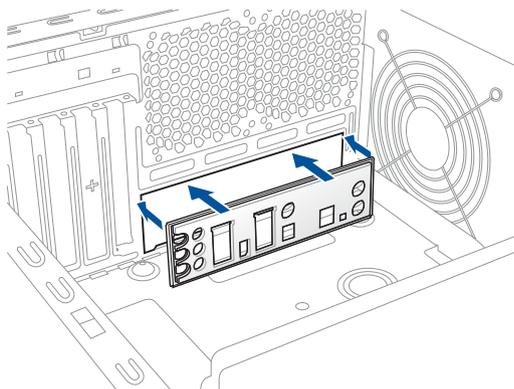
2. PCケースとマザーボードのバックパネルの位置が一致していることを確認してバックパネル側から慎重に挿入し、マザーボードの取り付け穴とスペーサーが合うように設置します。
